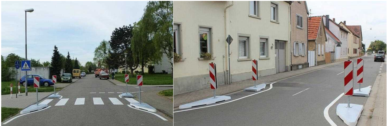
Abbildung 2: Mit Kunststoff-Elementen hergestellte vorgezogene Seitenräume mit und ohne Fußgängerüberweg (Quelle: www.lueft.de )
