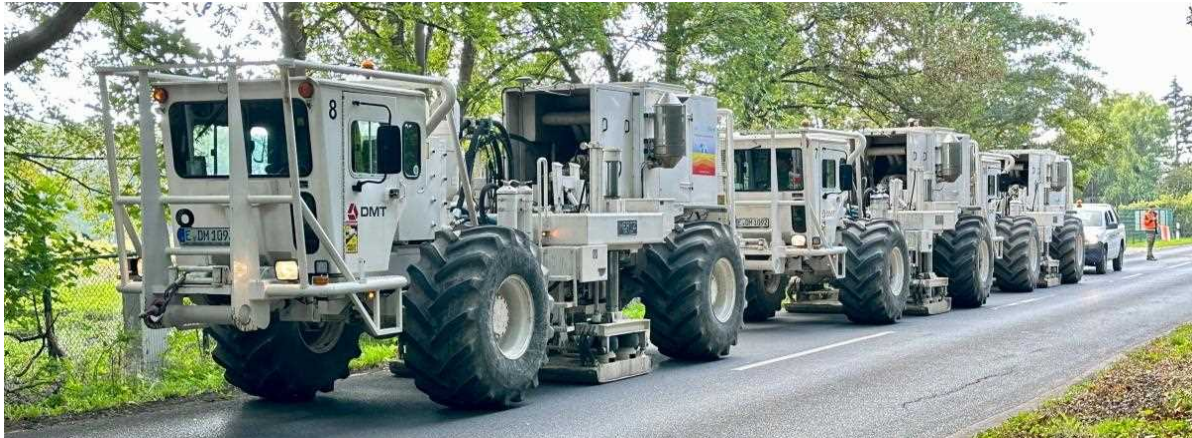
Abbildung 1: Seismische Messung durch Vibro-Trucks (Geologischer Dienst NRW)
