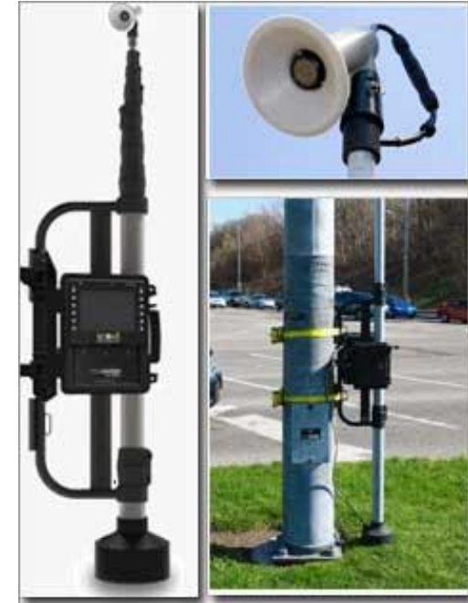
Aufgebaute Kamera für Verkehrserhebung (Quelle: IVV)
