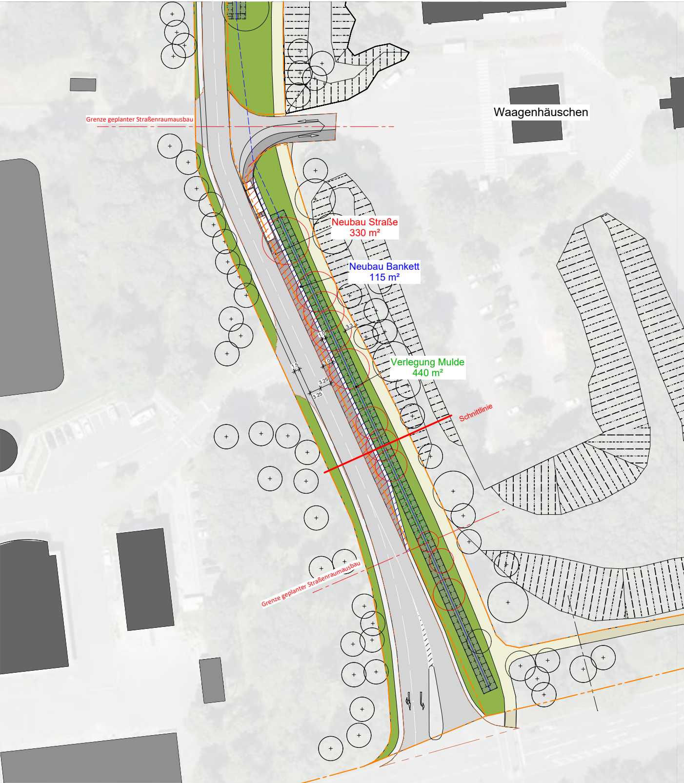
Abbildung 69: Aufstellspur Schelpmiser Weg - Variante A Übersichtsplan
