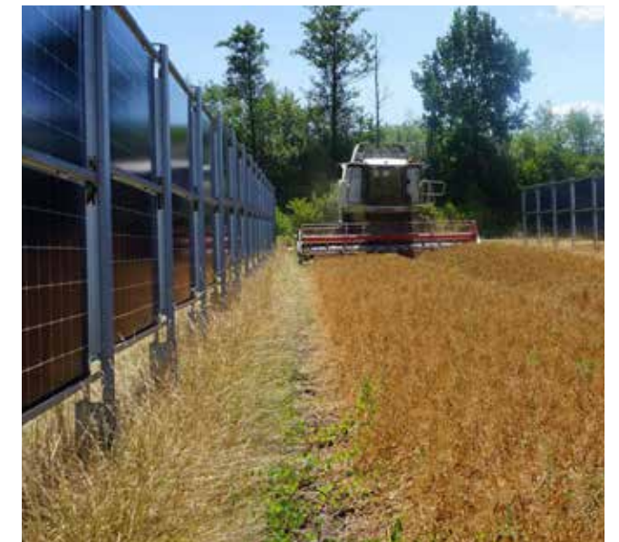
Abbildung 88: Beispiele einer vertikalen (bifazialen) Agri-PV-Anlage
