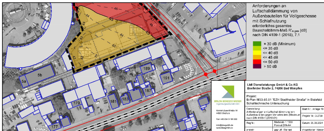
Darstellung 2: Anforderungen an Luftschalldämmung von Außenbauteilen für Vollgeschosse mit Schlafnutzung – erforderliches gesamtes Bauschalldämm-Maß R'_{w,ges} [dB] nach DIN 4109-1 (2018)
