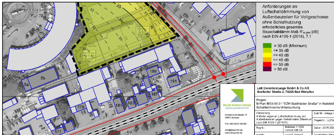
Darstellung 2: Anforderungen an Luftschalldämmung von Außenbauteilen für Vollgeschosse mit Schlafnutzung – erforderliches gesamtes Bauschalldämm-Maß R'_{w,ges} [dB] nach DIN 4109-1 (2018)
