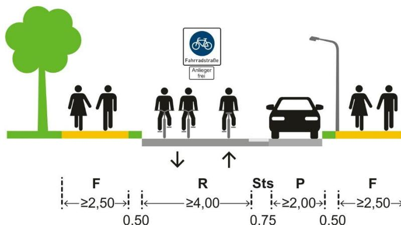
Abb. 4 Führung der RSV als Fahrradstraße (schematische Darstellung nach FGSV, EG RSV 2014)
