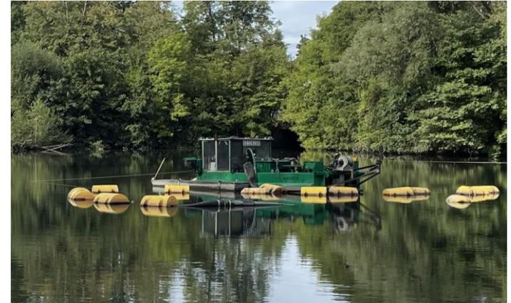
Abb. 2: Schwimm-Saugbagger
