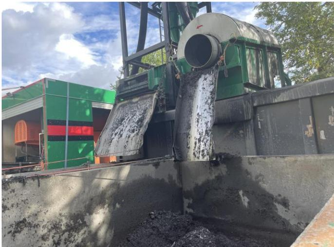
Abb. 3: Entwässerungsanlage (Sieb, Hydrozyklon, Zentrifuge)
