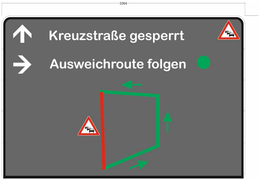
Abbildung 4.2: Beispiel für Ausweichroutenempfehlungen auf einem LED-AQ
