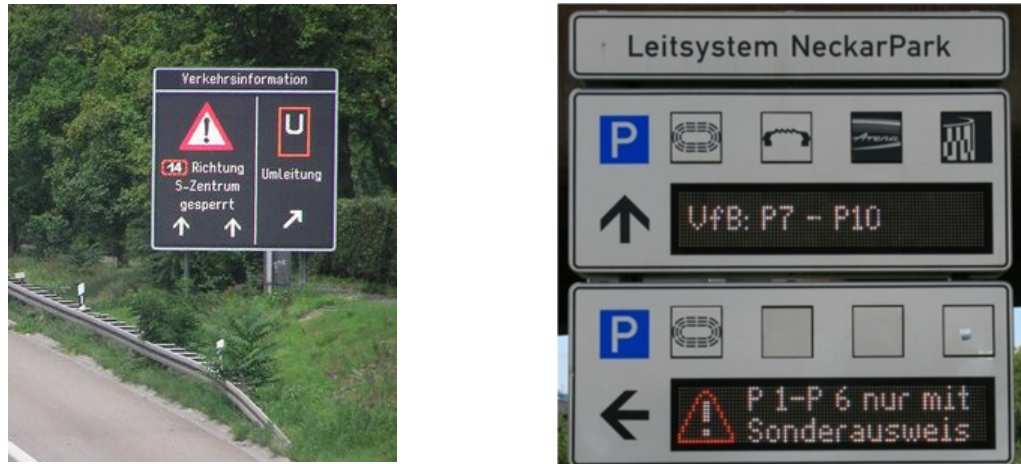
Abbildung 3.5: Vario-Tafel (links) und dynamische LED- Parkanzeige (rechts) in Stuttgart 7
