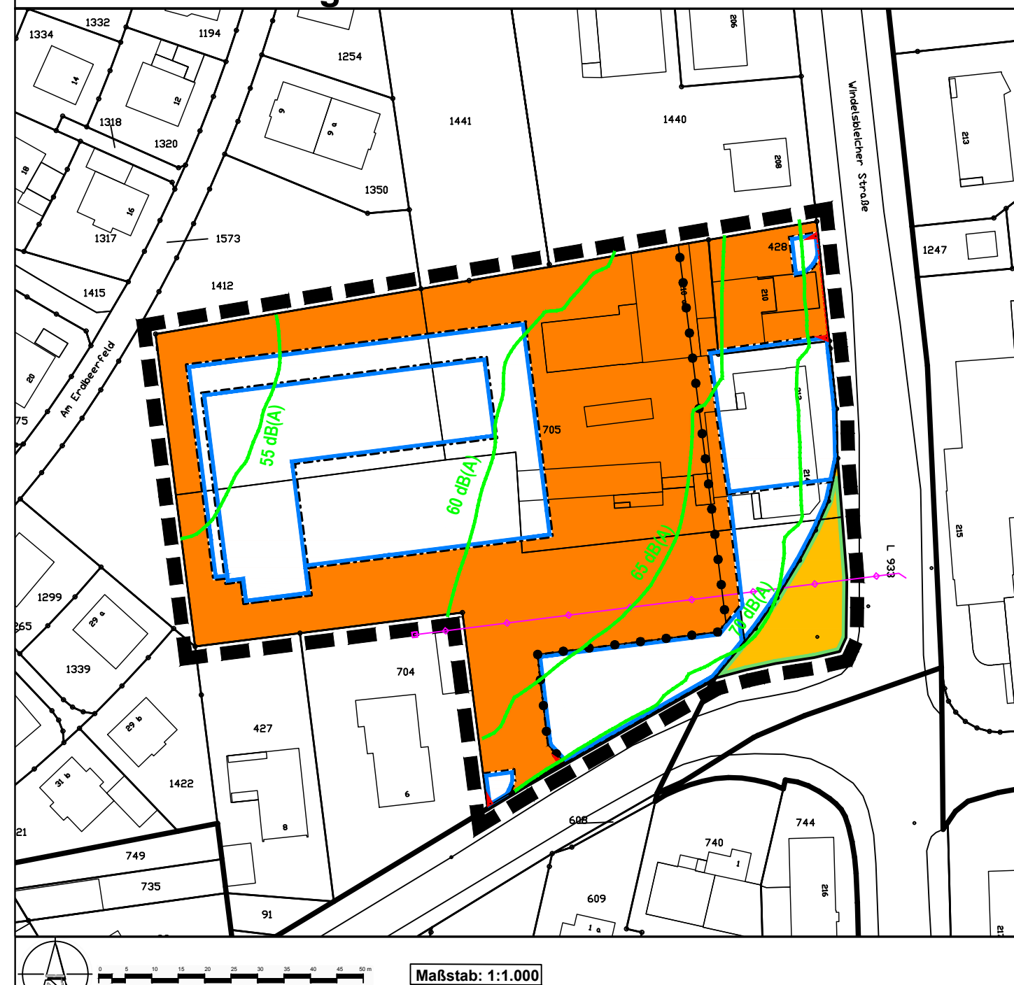
PLANZEICHNUNG TEIL 2: Maßgebliche Außenlärmpegel tags im EG gem. DIN 4109-1 (2018) - freie Schallausbreitung
