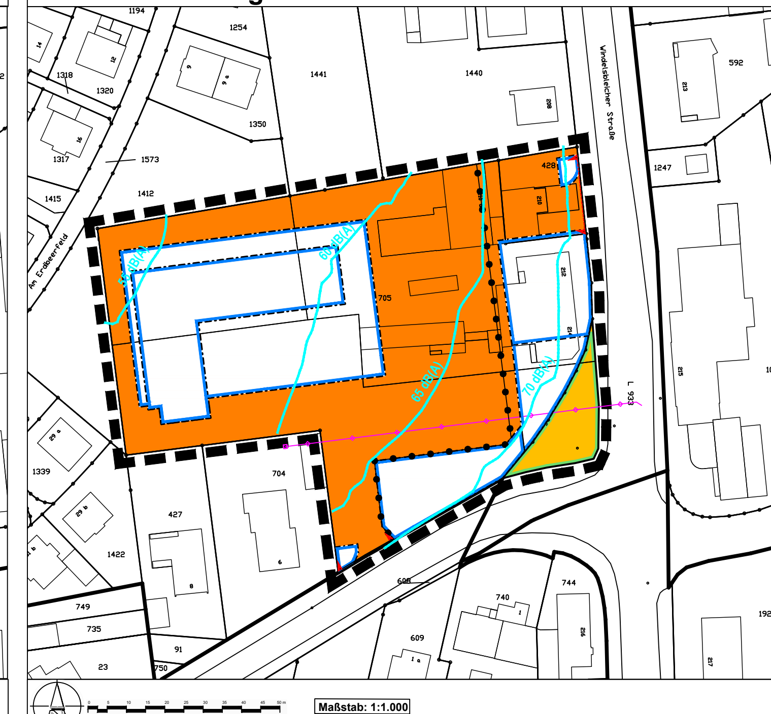
PLANZEICHNUNG TEIL 3: Maßgebliche Außenlärmpegel tags im OG gem. DIN 4109-1 (2018) - freie Schallausbreitung
