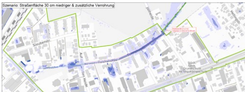
Abb. 83: Überflutungen bei einem extremen Starkregen ( h_N=90 mm) im Bereich der Straße Teichsheid (Bildmitte), bei Absenkung der Straßenfläche um 30 cm und Simulation einer zusätzlichen Verrohrung am östlichen Ende der Straße
