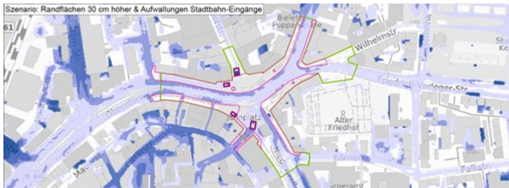
Abb. 89: Überflutungen bei einem extremen Starkregen ( h_N=90 mm) im Bereich des Jahnplatzes (Bildmitte), bei Anhebung der Gehwegflächen im Bereich des violett umrandeten Gebietes um 30 cm
