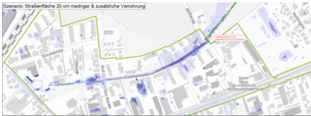
Abb. 82: Überflutungen bei einem extremen Starkregen ( h_N=90 mm) im Bereich der Straße Teichsheid (Bildmitte), bei Absenkung der Straßenfläche um 20 cm und Simulation einer zusätzlichen Verrohrung am östlichen Ende der Straße
