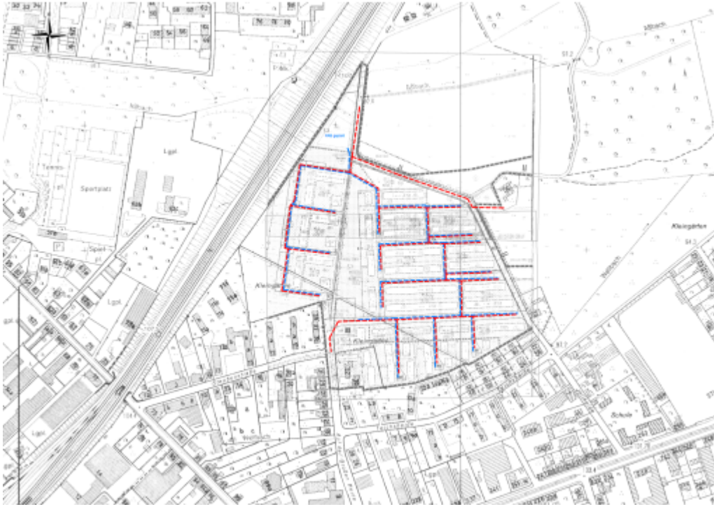
Abb. 79: Geplantes Trennsystem im Bereich des B-Planes Jöllheide
