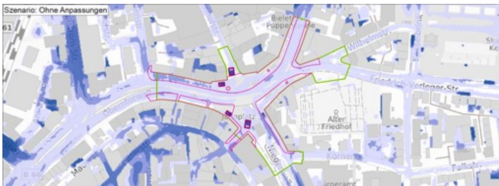
Abb. 87: Überflutungen bei einem extremen Starkregen ( h_N=90 mm) im Bereich des Jahnplatzes (Bildmitte), ohne Anpassungen der Oberfläche (Randbedingungen der Simulation wie beim entsprechenden Szenario der Starkregengefahrenkarte)
