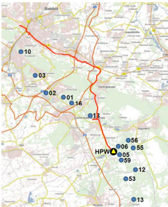
Bis zum Endpunkt finden aus der ZW2 Auspeisungen zu den Wasserbehältern Weißer Weg, Sieker und Sparrenberg statt, über die das innerstädtische Hauptwasser-Netz versorgt wird. Im Bereich Oerlinghausen ist als Besonderheit die Leitung in einem begehbaren, ca. 450 m langen Stollen verlegt worden.
