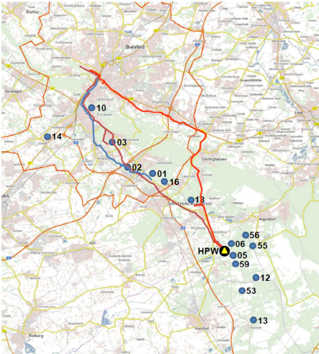
Abb. 25: Transportsystem der ZW-Leitungen (rot, braun und blau) mit Hauptpumpwerk (HPW) und einspeisenden Wasserwerken (Quelle: Stadtwerke Bielefeld, 2017)
