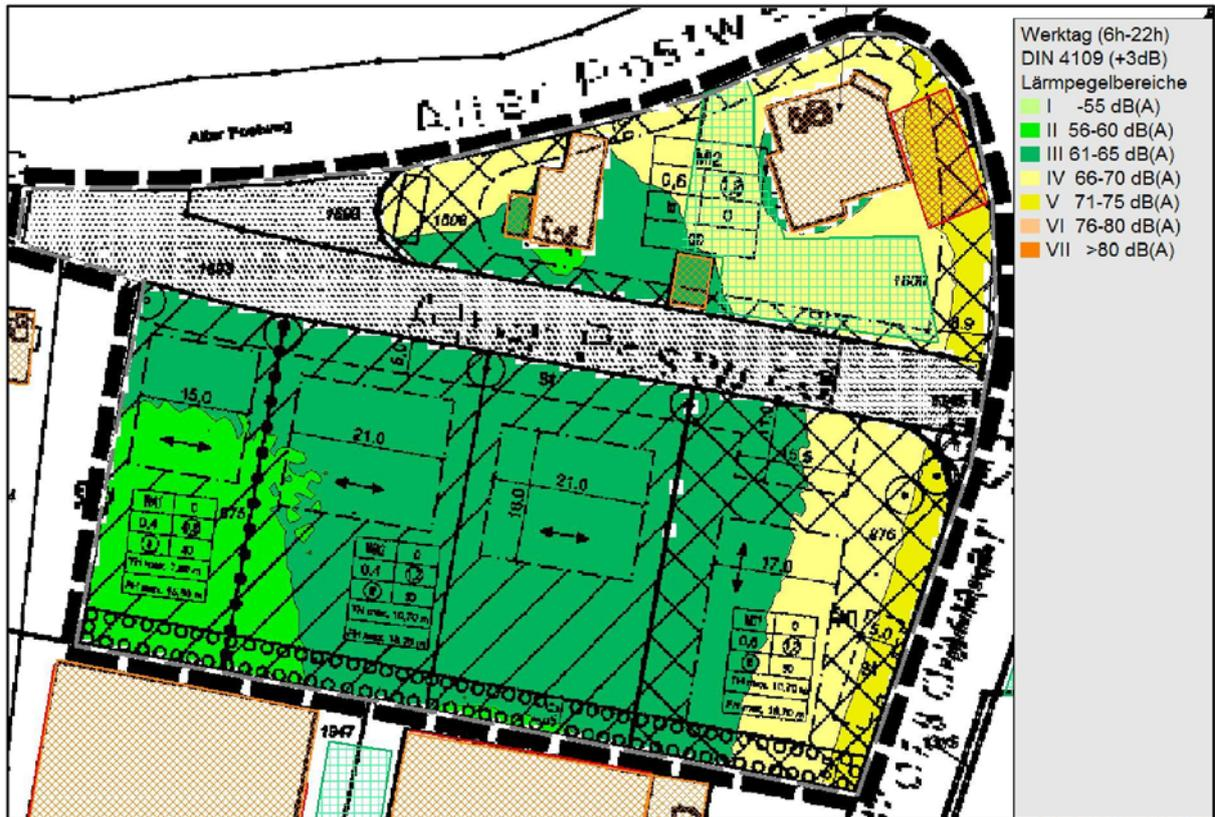
Abb.7: Flächenhafte Darstellung der Lärmpegelbereiche gemäß DIN 4109 ohne zusätzliche Schallschutzmaßnahmen (DEKRA Automobil GmbH)
