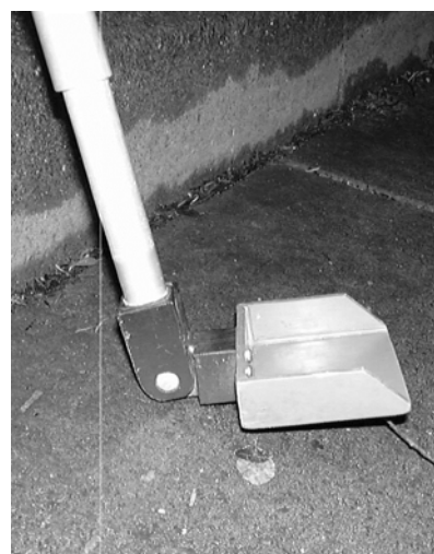
Schaufel zum Abkratzen der Sielhaut Teleskopstange ersetzt den Einstieg in den Kanal (nur nachts möglich)
