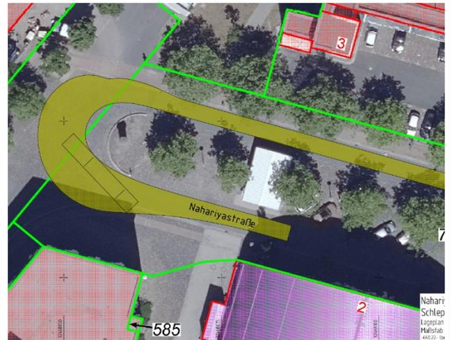
Abbildung 6: Analyse der Busschleppkurve auf der Nahariyastraße
