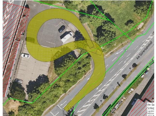
Abbildung 4: Analyse der Busschleppkurve auf der Straße „Am Güterbahnhof“
