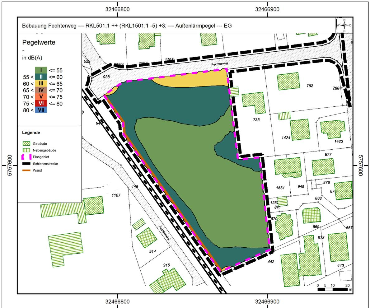
Abbildung 6: maßgeblicher Außenlärmpegel in Lärmpegelbereichen im EG auf Basis der Tageswerte
