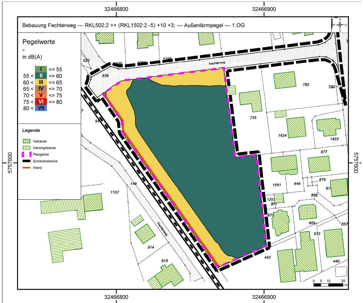
**Abbildung 9: maßgeblicher Außenlärmpegel in Lärmpegelbereichen im 1.OG auf Basis der Nachtwerte**
