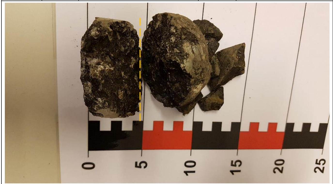
Bemerkungen: Kern bei der Probenentnahme zerbrochen
