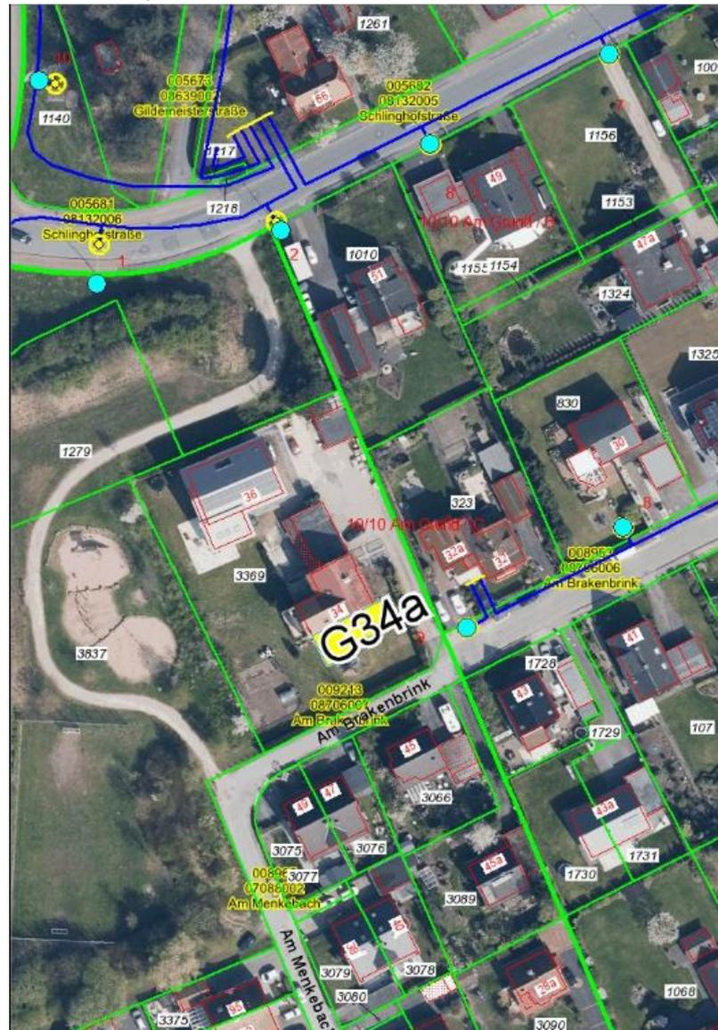
Der vorgenannte Weg befinde sich auf dem Gelände des Immobilienservicebetriebes (ISB) und sei zurzeit ohne jedwede Beleuchtungseinrichtung. Bei einer Neuinstallation sei von der Schlinghofstraße kommend ein neues Beleuchtungskabel über eine Länge von ca. 150 Meter zu verlegen. Zur gleichmäßigen Ausleuchtung des Weges seien vier Straßenleuchten aufzustellen.
