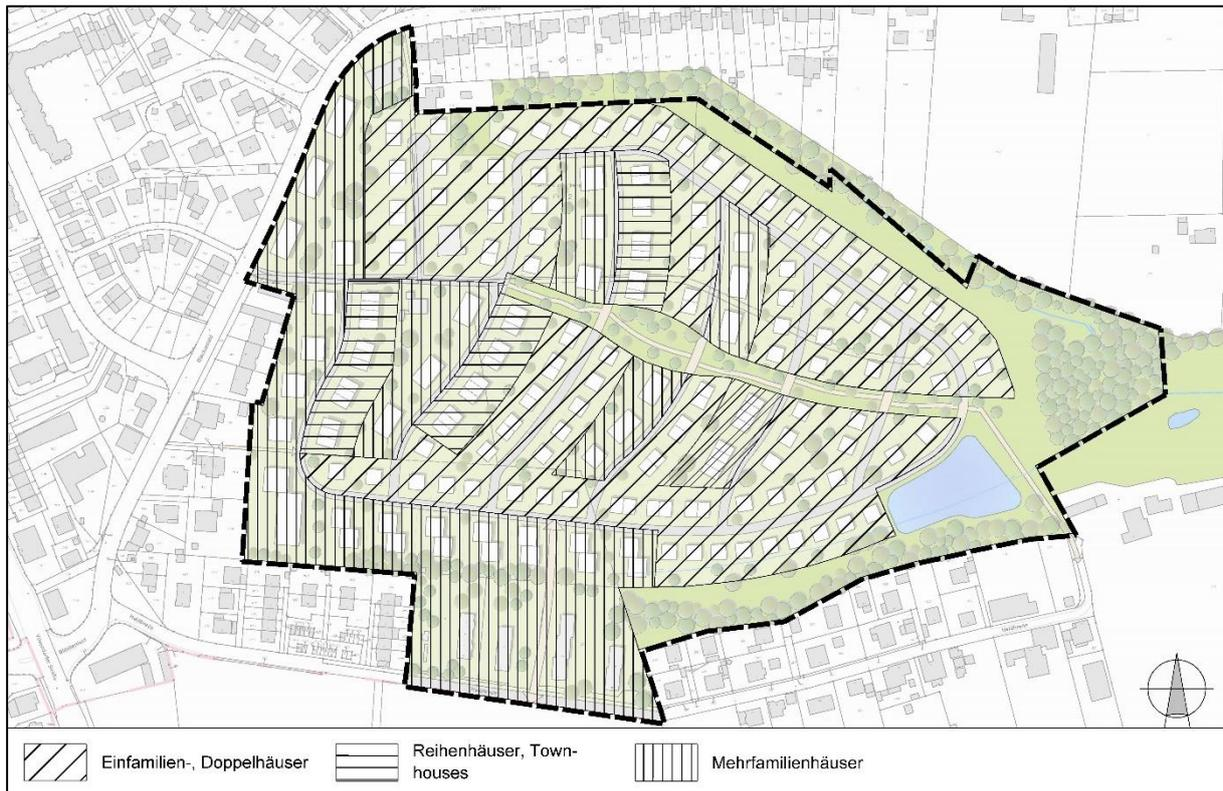
**Abb. 12: Verteilung der baulichen Dichte / Haustypen, o. M.**
