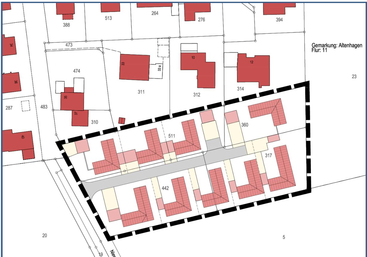
Ideenskizze zur Neuaufstellung mit eingeschossigen, winkelförmigen Einfamilienhäusern
