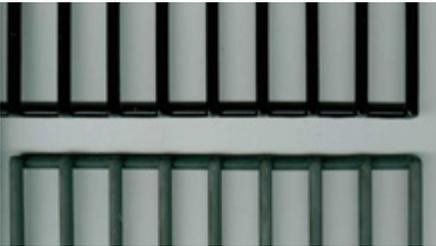
Abb. 3: Grillroste schwarz (oben Original, unten nach der Prüfung)
