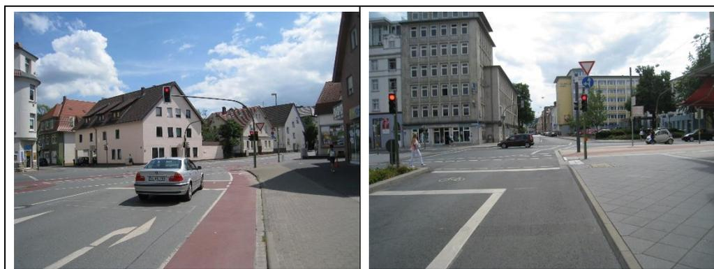
Bild 7: Radfahrstreifen in unzureichender Breite sowie Aufstellbereiche für den Radverkehr im Zuge der Oststraße (links), Vorbeifahrstreifen und aufgeweitete Aufstellbereiche im Zuge der Tunerstraße (rechts)
