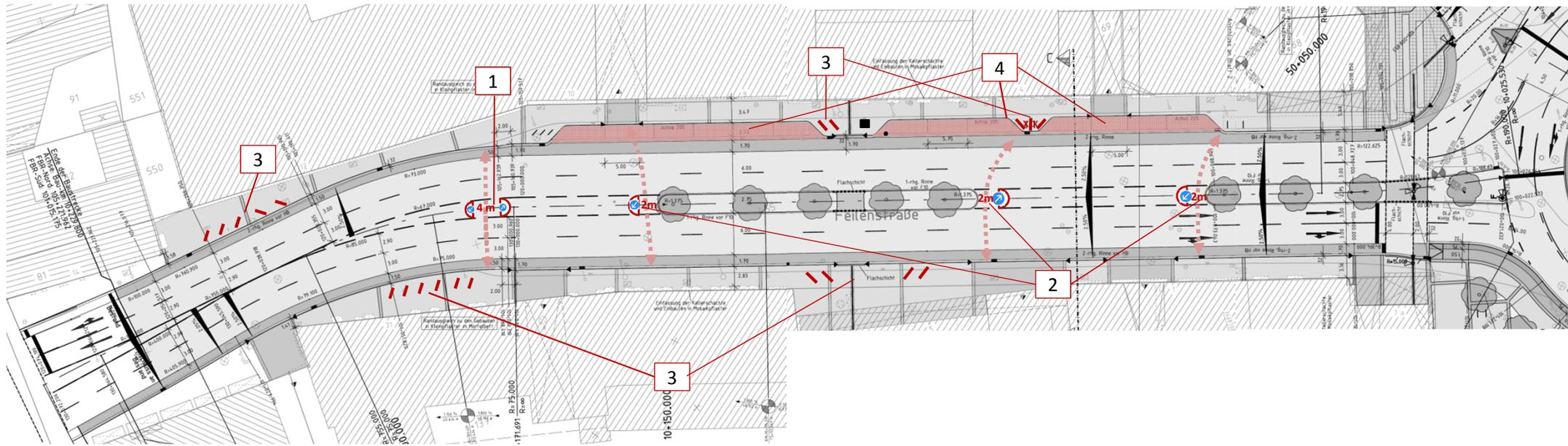
1. Einbau einer provisorischen (und damit nicht barrierefreien) geklebten Querungshilfe in der Feilenstraße als zusätzliche Querungsmöglichkeit. Dadurch wird für Fußgänger und Radfahrer eine weitere sichere Querungsmöglichkeit geschaffen.
