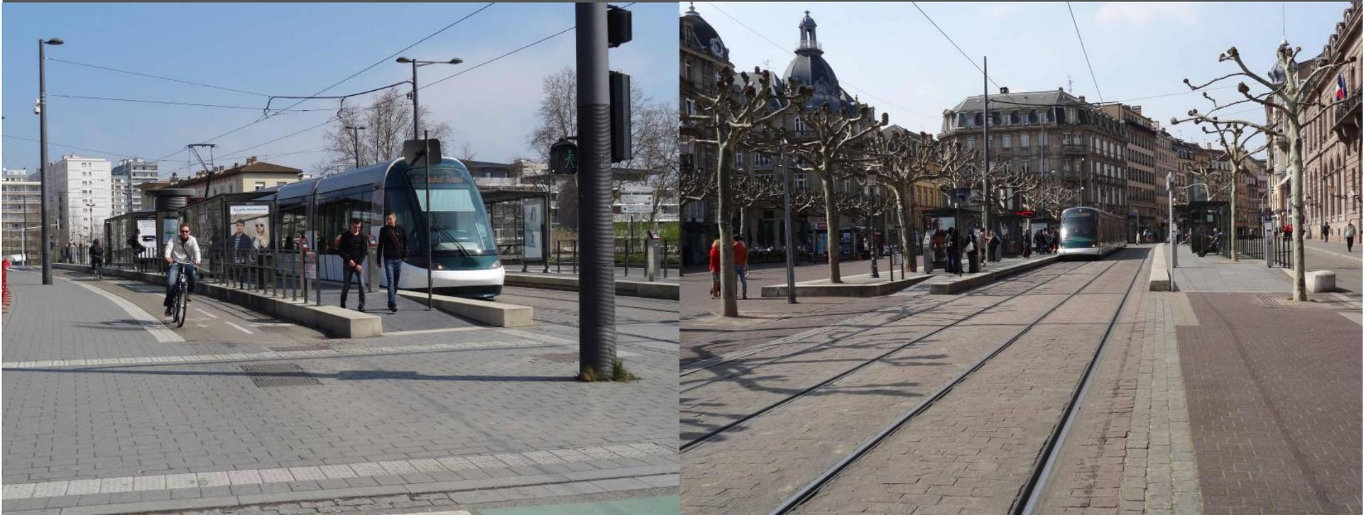
Durch Weiterentwicklung der Fahrzeugtechnik kann die Barrierefreiheit nun auch im Niederflerbereich erreicht werden
