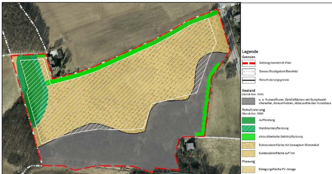
Abb. 25 Ausschnitt Rekultivierungsplan mit überlagelter PV-Anlage
