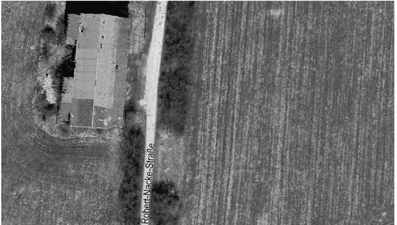
Beide Scheunen sind in erheblichem Maße baufällig. Teilweise (Tore, Dächer - siehe Luftbild !) besteht bereits Einsturzgefahr, so dass beide Gebäude derzeit mit einem Bauzaun gegen unbefugtes Betreten gesichert sind.
